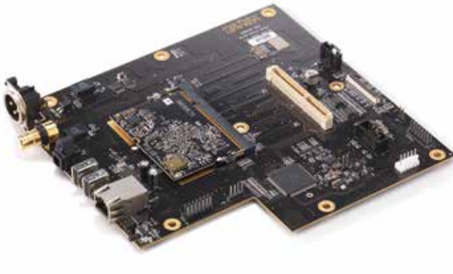
這是處理Streaming相關運作的主線路板，機器內部的電腦線路採用Linux系統，避免受到其他系統的制約。
