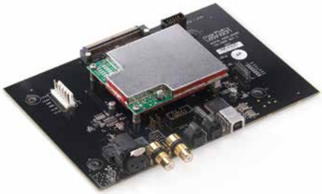
這是No.519的數類轉換線路「The Precision Link DAC」，晶片採用ESS Sabre 32晶片，並內建Jitter降低線路。
