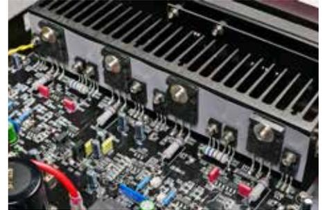
3 H80的功放電路應用獨家的「Sound Engine」技術：在每個放大級的輸出端偵測輸出信號的誤差、結合前授電路在放大級的前端作即時修正，這樣能有效解決功率晶體配對、交越失真以及正負半波不對稱的問題，使諧波失真降得極低（尤其是高頻）。
