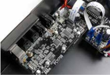
1 本機的數類轉換電路板位於機內的左後方，分別以Tenor TE7022與AKM AK4118作為USB Audio與S/PDIF輸入介面，隨後以AKM AK4127 SRC晶片作升頻處理之後、用Burr-Brown PCM1754 192kHz/24bit晶片將數位音訊轉換為聲頻信號。
