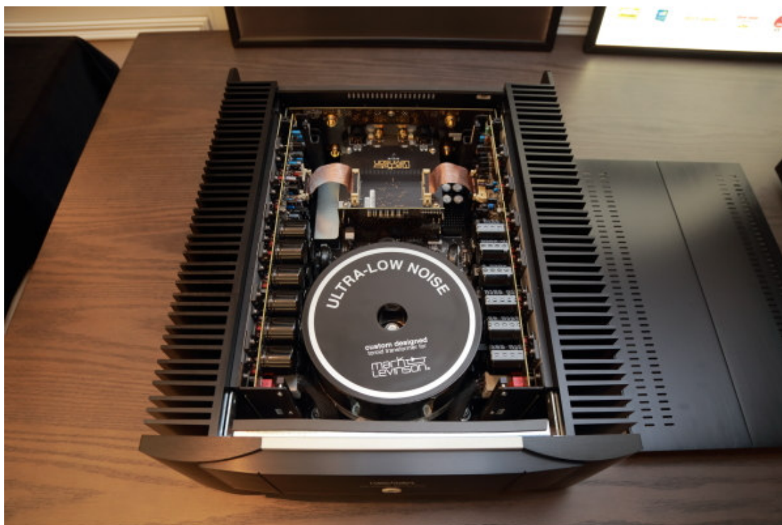
打開機箱蓋的 No.534 後級，可以看到體積非常驚人的訂製環形變壓器。
