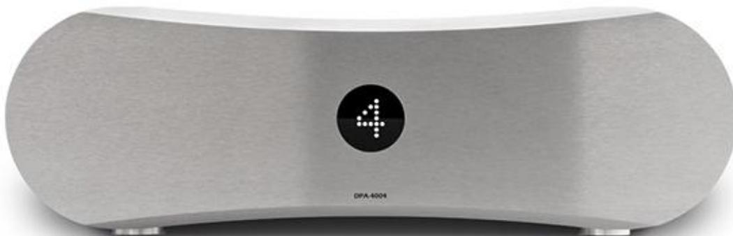
原廠推薦 DPA-4004 的完美匹配是 Gato Audio PRD-3s DAC 前級，也可加上 Gato Audio 的 DIA-250S 或 DIA-400S 綜擴，與多聲道系統一起整合。DPA-4004 電路建置設計 Class D 放大，實測數據證明 DPA-4004 的能力：總諧波失真 0.01%、頻率響應 20Hz-20kHz(誤差-0.5dB)、2Hz-70kHz(誤差-0.3dB)。訊噪比不小於 114dB。還可以從內部電路版中調整增益，調整範圍-2dB 至+6dB。DPA-4004 這四聲道後級還可以做彈性設定，在 4 聲道輸出的模式下，DPA-4004 每聲道可輸出 400 瓦功率，切換為兩聲道模式時，功率大幅提升為 1400 瓦，幾乎提升了快四倍，可以從四聲道變兩聲道，達到功率大增的效果，DPA-4004 還可以切換三聲道模式，變成一個聲道 1400 瓦，兩個聲道各擁 400 瓦，這麼豐富又多樣的搭配，讓 DPA-4004 不管是兩聲道或多聲道系統，都能讓您彈性搭配，實用性相當高。
