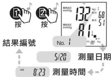
在顯示螢幕右上方，可切換顯示結果編號、測量日期、測量時間。
