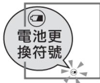
電池更換符號顯示時，請把全部4個電池都換成新電池。
