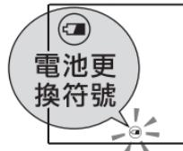
電池更換符號顯示時，請把所有4個電池都換成新電池。請使用同種類的電池。請勿混用種類不同電池或者新舊電池。
