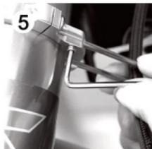
油管支架止付螺絲鎖緊
