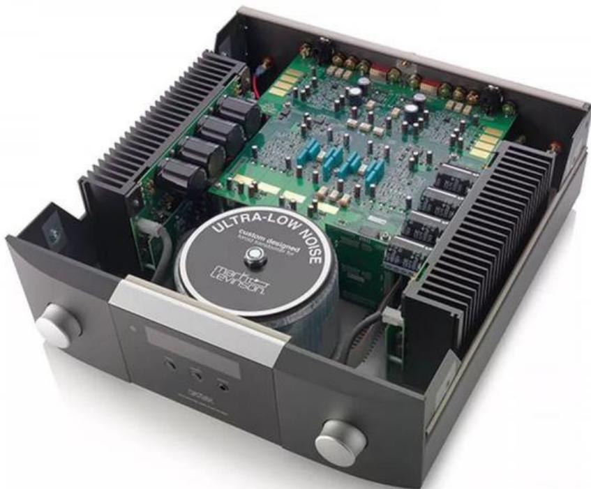
No.5802的內部安排得很方正，環形變壓器在前方正中央，左右二側是散熱片與功率輸出級，中央則是數位線路板，整部機器幾乎看不到配線。
