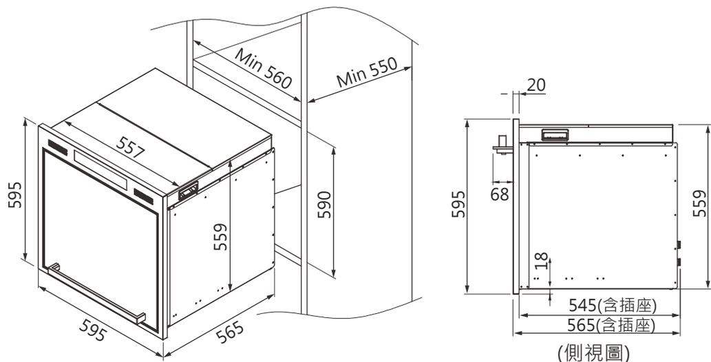
安裝示意圖 (單位:mm)
