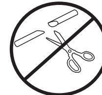
**!** 裁剪水管時，請將水管管口剪平，切勿裁剪成斜切面。
