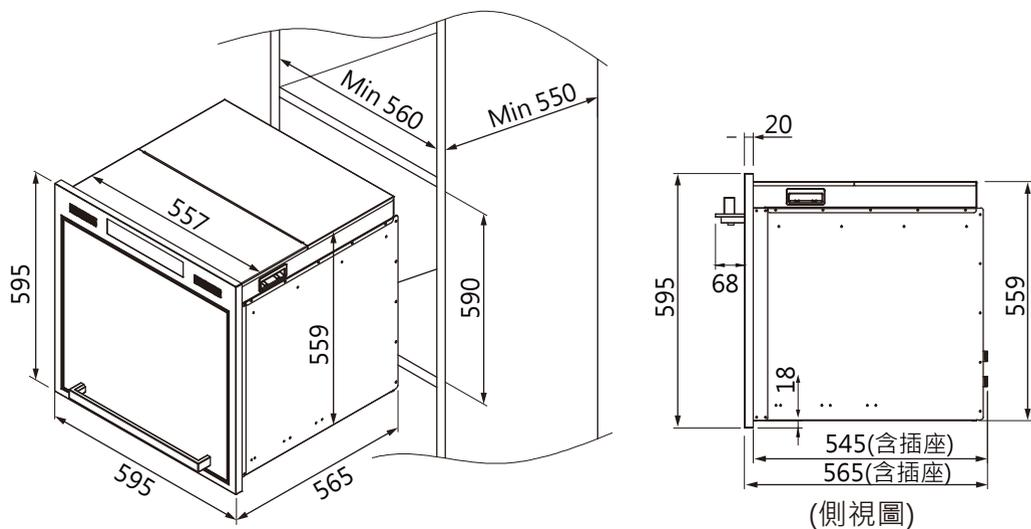
安裝示意圖 (單位:mm)
