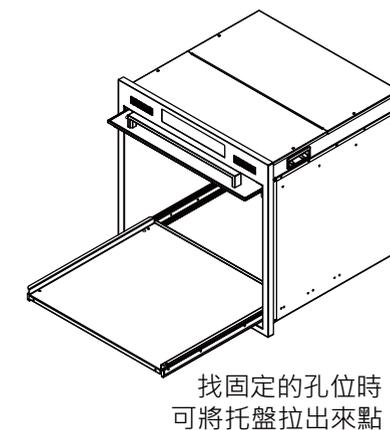
※建議可將托盤部分移出，或將托盤先拆開取出，易於找到滑軌上的固定孔位(做記號)。
