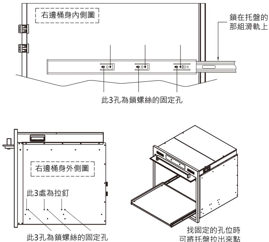
※建議可將托盤部分移出，或將托盤先拆開取出，易於找到滑軌上的固定孔位(做記號)。
