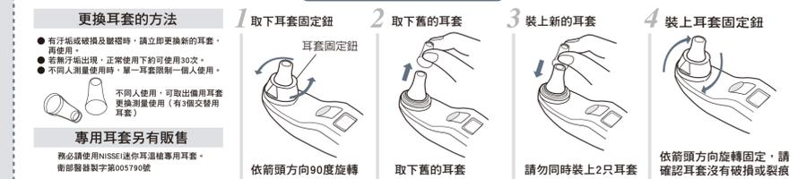
注意：請勿以手觸摸或撞擊測溫頭以及耳套前端。若黏上黏汗，會導致溫度測量異常或故障發生。請使用專用的耳套。若使用非專用的耳套，可能導致溫度測量異常或故障發生。
