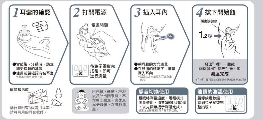
正確插入耳朵測量的方式：測量前，就以自己耳朵測試或正確使用方式。耳孔不是筆直延伸。耳孔隨著成長乃是呈現S形方向。插入太淺，僅測量到耳道的外耳壁，插入的方向並不正確。無法測量到正確的位置。朝向耳朵深處的方向測量。插入時，請將耳背輕輕拉直，測溫頭方向直入耳內 (鼓膜) 保持一定方向和深度。
