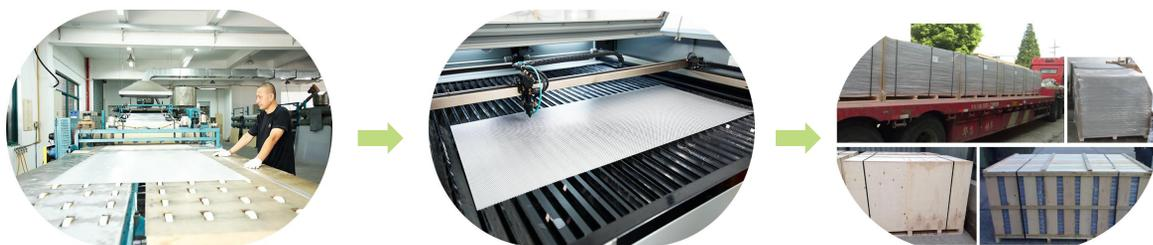
1. 挤出成型: 挤出机熔融通过模具挤出后成型为片材, 板材覆膜保护。
