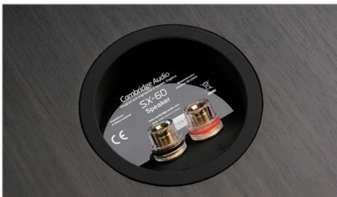
▲左：看來相當平凡的軟膜高音單體，竟表現出相當好性能。右：背板接線端子相當簡潔，並未留下Bi-Wire的空間。
