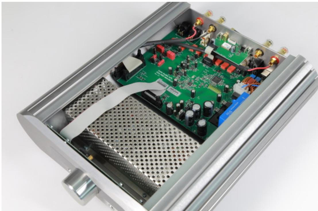
位於金屬網罩內的，便是 DIA-250S 所使用的 D 類擴大模組，8 歐姆承阻下，各聲道輸出功率可達 250 瓦；若在 4 歐姆承阻下，各聲道輸出功率可達 500 瓦，顯示電流供應十分充裕。
