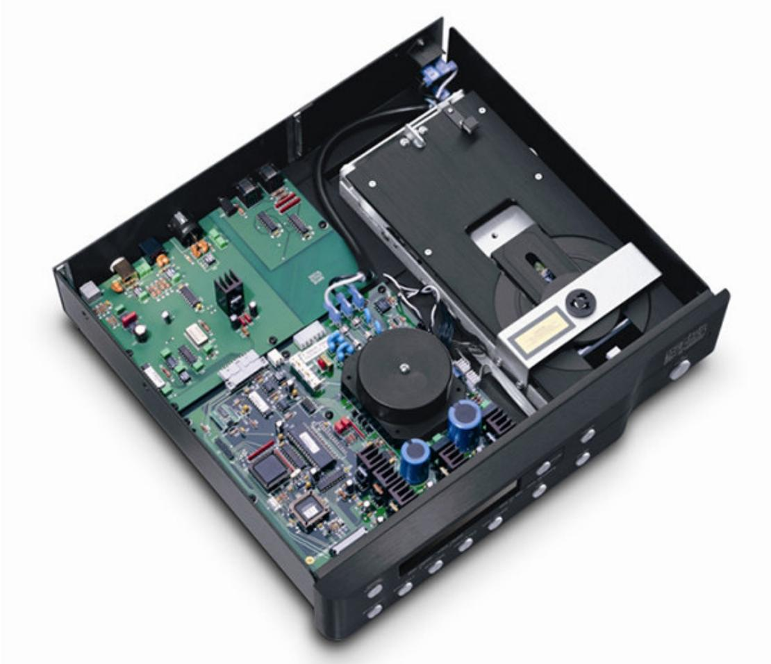
使內部使用了精度高於 **0.0005%** 的溫度補償石英振盪器來控制它的參考頻率時鐘，令其可以產生比先前機種更穩定的參考頻率。
