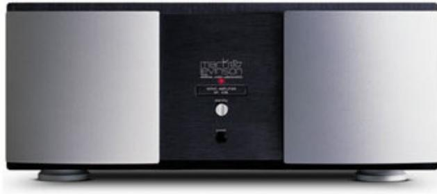
No. 434 和 No. 436 分別為 125 瓦和 350 瓦的單聲道後級，這個誕生於 2000 年的「次世代」產品，取消了傳統外張式的散熱片，將散熱片做在機箱內部，並以風扇輔助散熱，不但使外觀更簡潔，這樣的設計更讓用家可以選購多台，構建多聲道系統。
