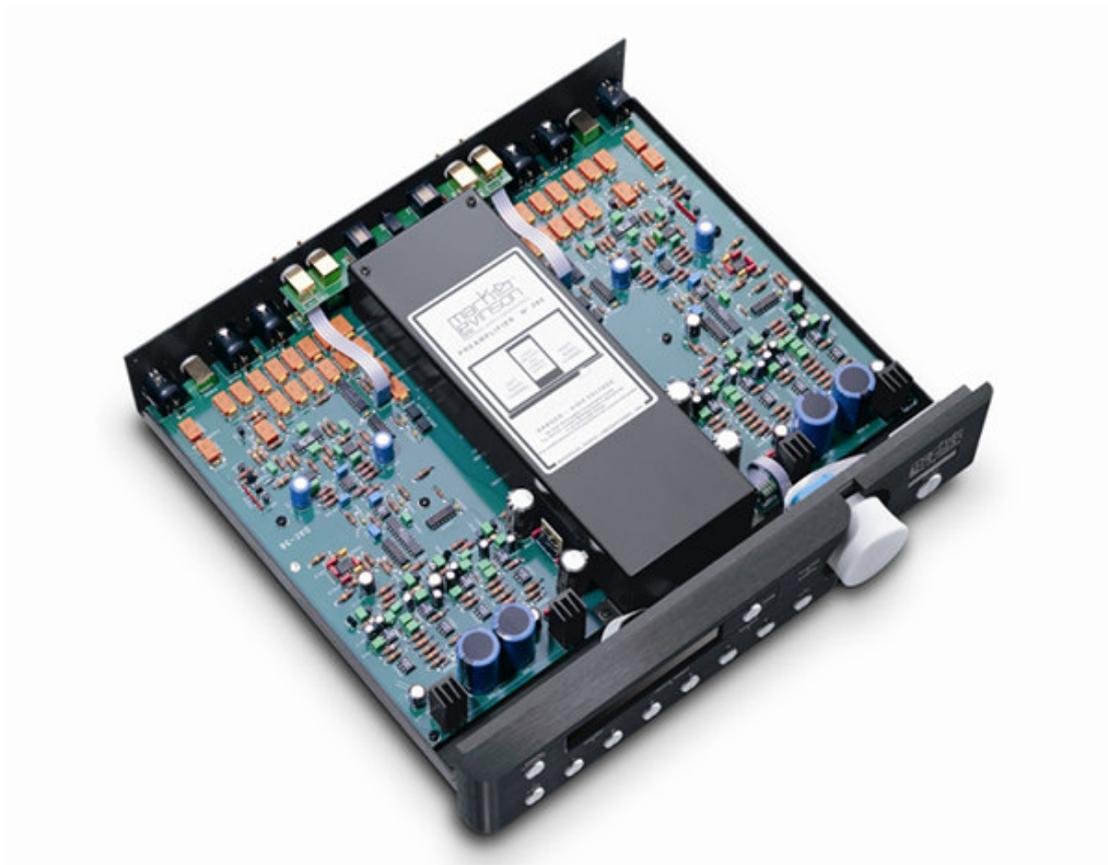
從 No. 38/ No. 38s 衍生的新版本前級，基本架構與線路設計都延續前代機種，但原廠在其中使用了超過 100 個新元件。
