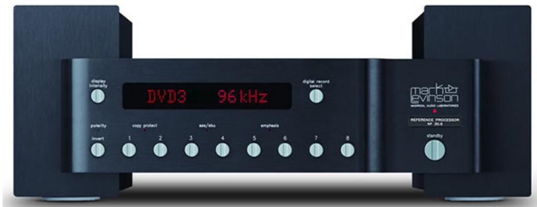
延續 No. 30 和 1994 年的 No. 30.5，No. 30.6 也是 Mark Levinson 的參考級 DAC，採用鐵弗龍電路版，從數位訊號輸入端起直到類比訊號輸出，一路都是平衡線路；實現極低噪訊的目標。
